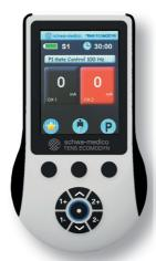
Le programme qui s'affiche est le dernier programme utilisé avant la mise hors tension de l'appareil.
